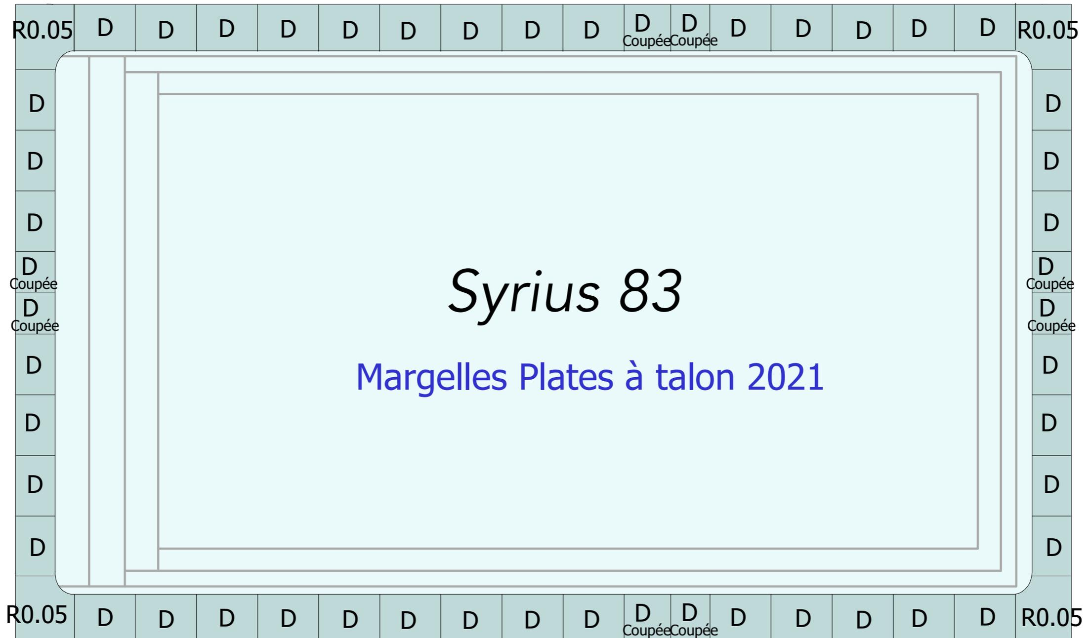
Diese Zeichnung dient nur zu Informationszwecken. Es wird notwendig sein, Schnitte auf bestimmte Randsteine durchzuführen, um die Kontour des Schwimmbeckens anzupassen (*bemerkt als « coupé » auf die Zeichnung*). Die Randsteine müssen auf ein perfektes ebenes Stahlbetonverband und mit gleicher Klebstoffstärke über die gesamte Breite gelegt werden.
