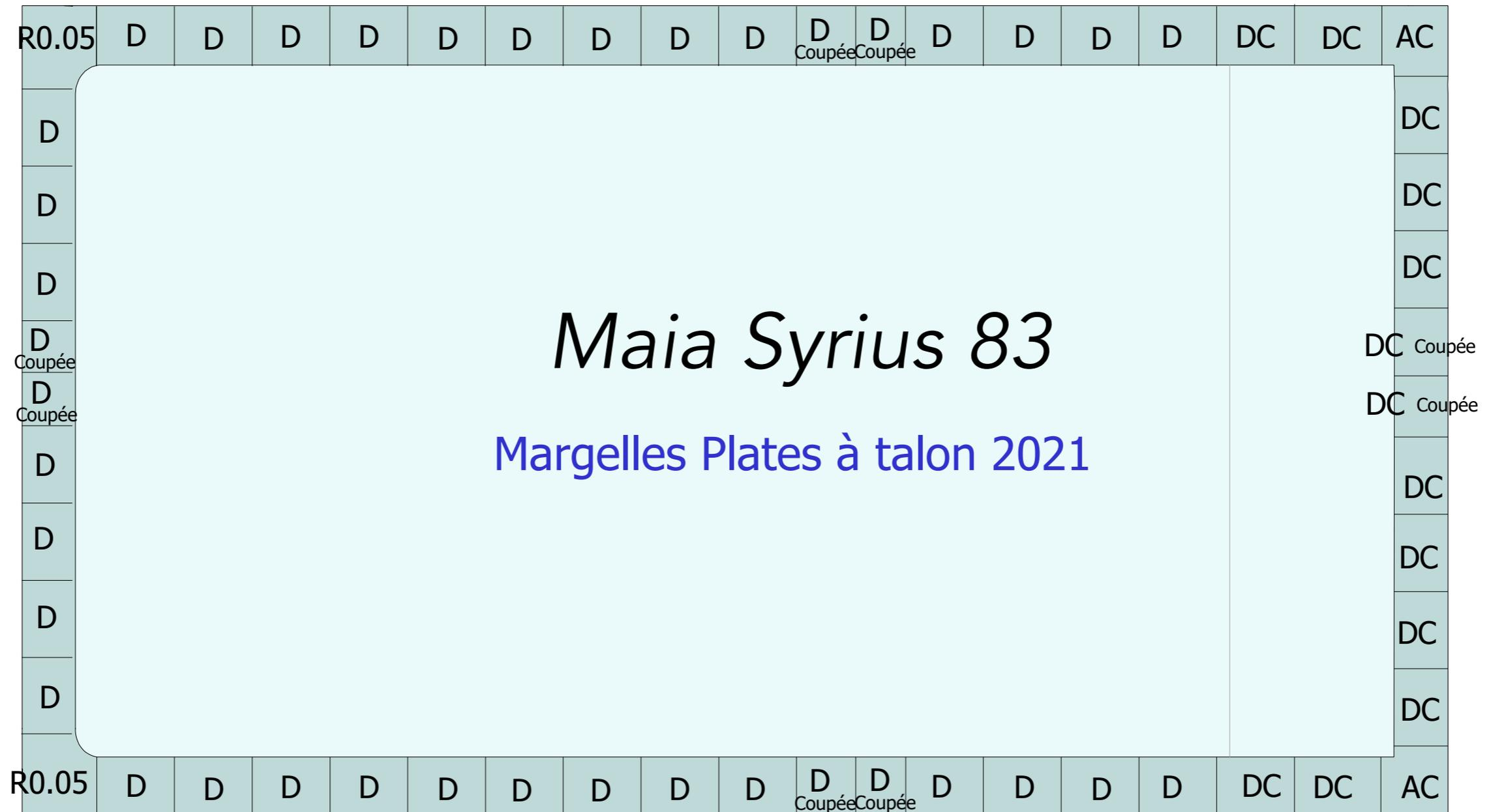
Diese Zeichnung dient nur zu Informationszwecken. Es wird notwendig sein, Schnitte auf bestimmte Randsteine durchzuführen, um die Kontour des Schwimmbeckens anzupassen (*bemerkt als « coupé » auf die Zeichnung*). Die Randsteine müssen auf ein perfektes ebenes Stahlbetonverband und mit gleicher Klebstoffstärke über die gesamte Breite gelegt werden.
