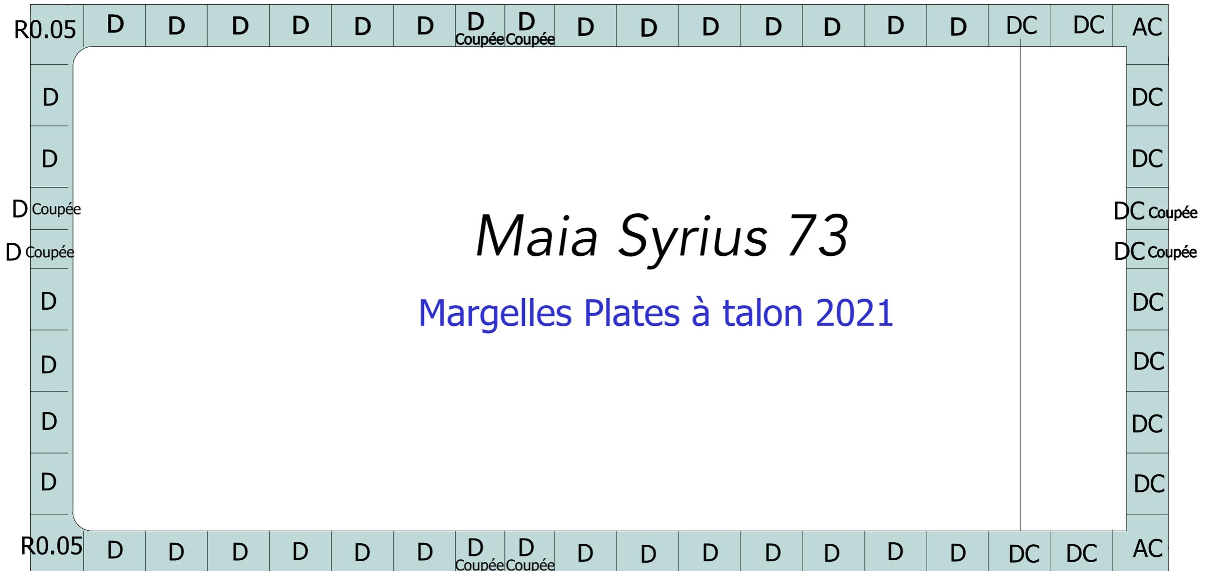
Diese Zeichnung dient nur zu Informationszwecken. Es wird notwendig sein, Schnitte auf bestimmte Randsteine durchzuführen, um die Kontour des Schwimmbeckens anzupassen (*bemerkt als « coupé » auf die Zeichnung*). Die Randsteine müssen auf ein perfektes ebenes Stahlbetonverband und mit gleicher Klebstoffstärke über die gesamte Breite gelegt werden.
