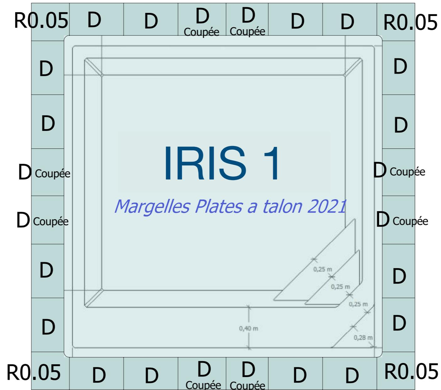
Diese Zeichnung dient nur zu Informationszwecken. Es wird notwendig sein, Schnitte auf bestimmte Randsteine durchzuführen, um die Kontour des Schwimmbeckens anzupassen (*bemerk als « coupé » auf die Zeichnung*). Die Randsteine müssen auf ein perfektes ebenes Stahlbetonverband und mit gleicher Klebstoffstärke über die gesamte Breite gelegt werden.
